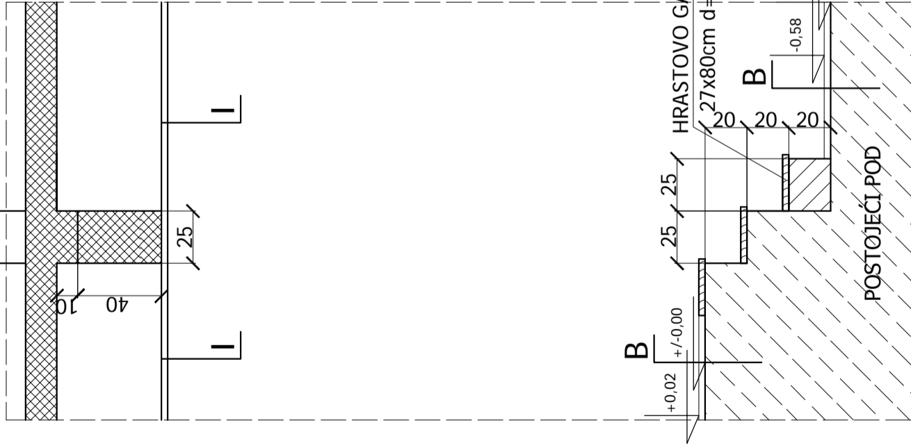
DETALJ STEPENICA U OPERATORSKOJ PROSTORIJI PREŠJEK
